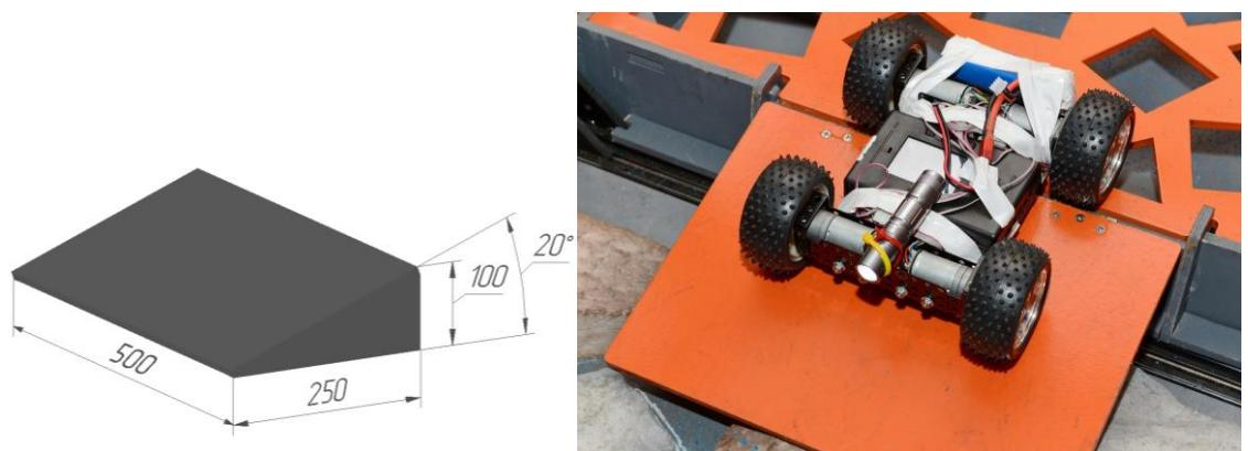
Рисунок 7 «Наклонная поверхность лабиринта 20°»
