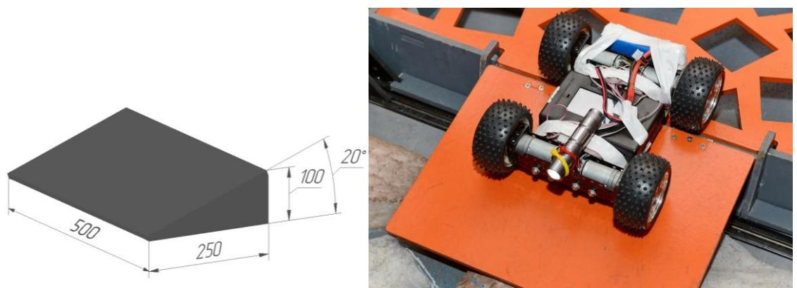
Рисунок 7 «Наклонная поверхность лабиринта 20°»
