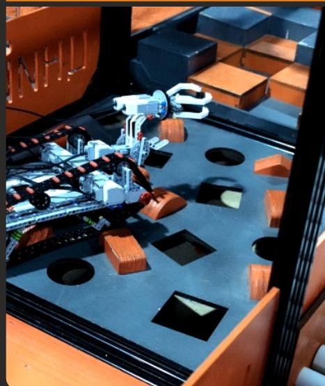
Испытание представляет собой стандартную ячейку полигона, заполненную наклонными рампами по 15° разной направленности. Рампы разной высоты с перепадом в 50 мм.
