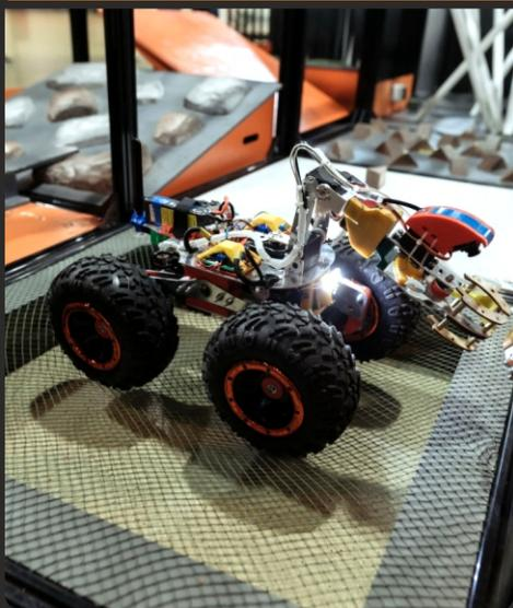
Данное испытание представляет собой каркас, с габаритами 740x740 мм. На каркасе натянута сетка. Сетка также может быть натянута на плоский каркас, который расположен вровень с металлическим профилем куба. Сетка слегка провисает из-за слабого натяжения. Размер ячейки в сетке - 10x10 мм. Материал сетки - тонкий капроновый шнур, плетение - узловое.
