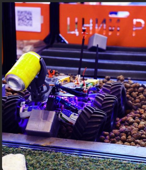
Короб с песком/керамзитом/проводами/шишками – испытание представляющее собой фанерный короб глубиной 40мм, заполненный различным сыпучим материалом.
