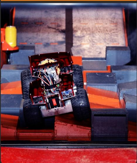
Это стандартная ячейка, заполненная коробами с углом наклона 15°, разной направленности. Рампы разной высоты с перепадом высот 50 мм.
