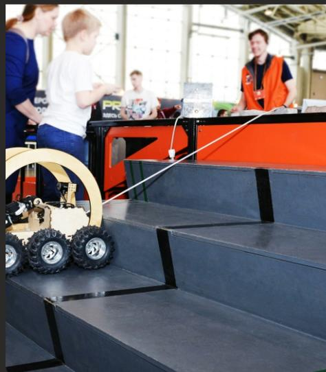
Испытание представляет собой стандартный куб полигона, внутри которого расположена лестница, ведущая на второй этаж полигона. Лестница состоит из восьми ступеней высотой 75мм и длиной 90мм. К лестнице ведёт стандартная наклонная (15°).
