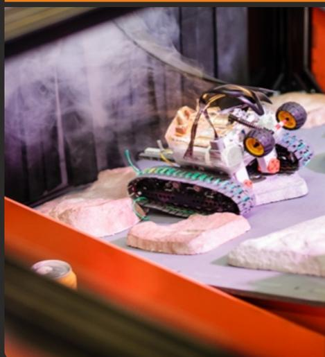
Испытание представляет собой наклонную 15°, с габаритными размерами 740x690x200, на которой закреплены камни. Высота камней – 15-40 мм.
