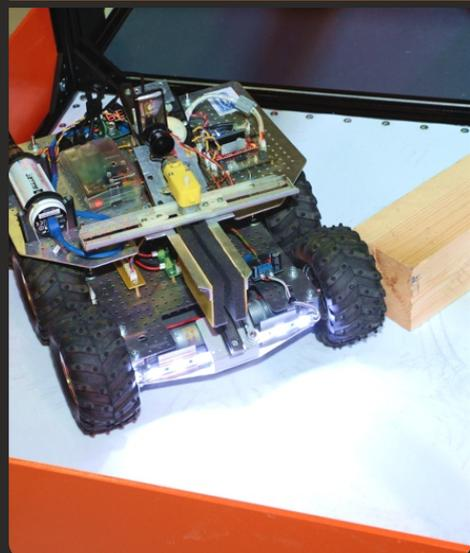
Скользкая поверхность (фторопластовая пластина), прикрепленная к листу фанеры. Габаритные размеры 740x740x10 мм. Для большей скользкости на поверхность наносится универсальная смазка WD-40.
