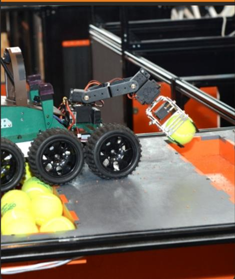
Испытание представляет собой фанерную площадку с двумя продолговатыми прямоугольными траншеями глубиной 40 мм. Длина траншеи составляет 670 мм, ширина – 140 мм. Одна траншея заполнена теннисными мячами (65 мм в диаметре), вторая пустая.
