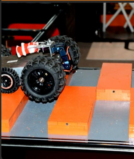
Испытание представляет собой фанерную площадку с чередующимися в шахматном порядке прямоугольными коробами с габаритными размерами 355x120x40 мм (ДxШxВ).
