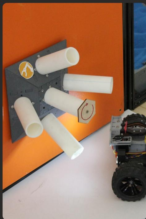
Задание представляет собой конструкцию из пластиковых труб, подвешенную на стенке ячейки. Каждая труба оканчивается шестиугольной крышкой со стороной 40мм. Длина подвижных труб 60мм.
