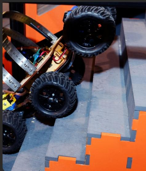
Фанерная конструкция с углом наклона 15°, с габаритными размерами 740x690x200.
