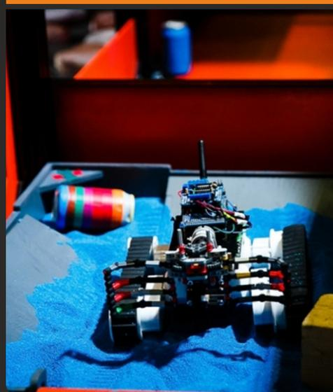
Испытание, представляющее собой короб, наполненный кварцевым песком (размер частиц 0,2-2,5 мм). Габариты короба 720x720x100. Высота песчаного слоя колеблется в пределах 20-30 мм. Внутри короба оборудованы наклонные съезды, снаружи к коробу приставляются наклонные поверхности.
