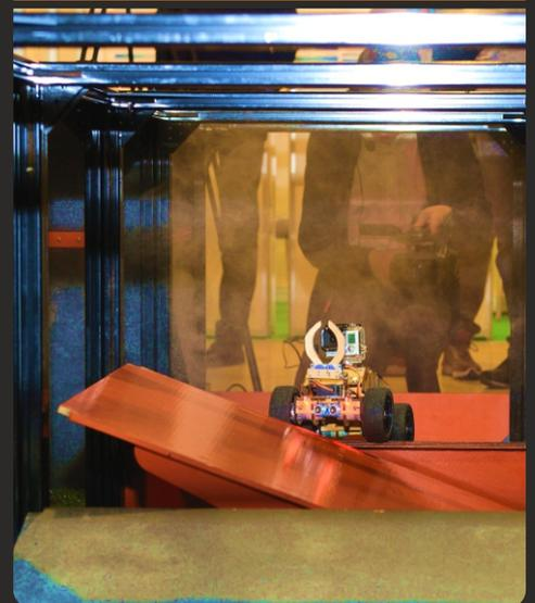
Испытание, представляющее собой короб, наполненный керамзитом, с фракцией частиц 10-20 мм. Габариты короба 720x720x100. Высота керамзитного слоя колеблется в пределах 20-30 мм. Внутри короба оборудованы наклонные съезды, снаружи к коробу приставляются наклонные поверхности с углом наклона не более 30°.
