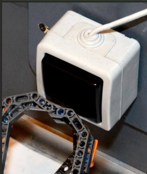
Обыкновенный бытовой выключатель для лампочки. При нажатии загорается светодиодная лента на участке «Туман». Кнопка расположена на высоте не более 70 мм от пола. При нажатии данной кнопки манипулятором обеспечивается прохождение попытки в зачёт.
