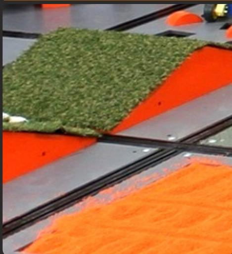
Испытание представляет собой двускатную наклонную 15°, с габаритными размерами 420x690x160, на которой закреплена полоса искусственной травы или камни. Высота ворса – 15 мм, габариты камней – произвольные, но высота камня не более 40 мм. Ширина боковых проемов по краям горки – 163 мм (считая профиль).
