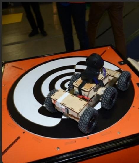
Гипнодиск представляет собой стандартный куб лабиринта, в котором расположен крутящийся с переменной скоростью диск диаметром 650 мм, закрепленный в верхней крышке. Материал диска – фанера 10 мм. Поверхность диска покрыта виниловой пленкой.
