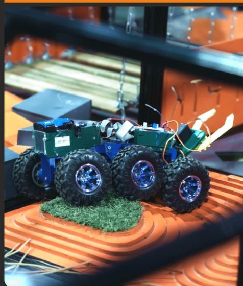
Испытание представляет собой послонную фанерную конструкцию, слои которой формируют два возвышения. Высота выступов - 70 и 50 мм. Интервал между слоями составляет 5 мм.
