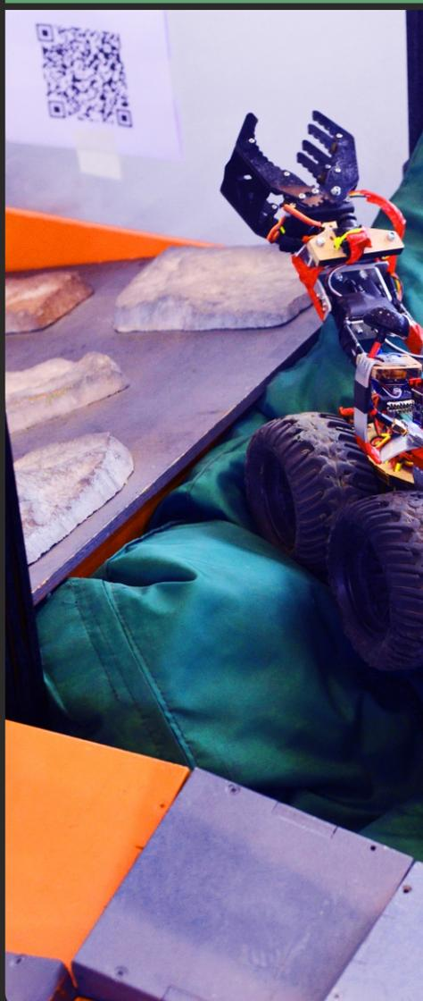
Задание, подразумевающее использование видеозрения или камеры робота. Доступно к выполнению только в номинации «Экстремал». Размеры QR-кода – от 50 до 120 мм. В коде зашифровано от 1 до 9 слов. Коды напечатаны на листах бумаги, и располагаются на различной высоте (50-200 мм) по всему полигону.
