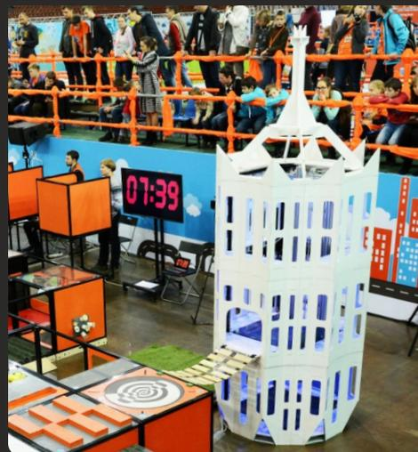
Подъемная конструкция, приходящая в движение при наборе роботом комбинации с помощью кнопок. Размеры платформы – 720х600 мм. Служит для подъема робота на верхний ярус башни, откуда робот может совершить задание «Прыжок веры». На первый ярус лабиринта лифт опускаться не может.
