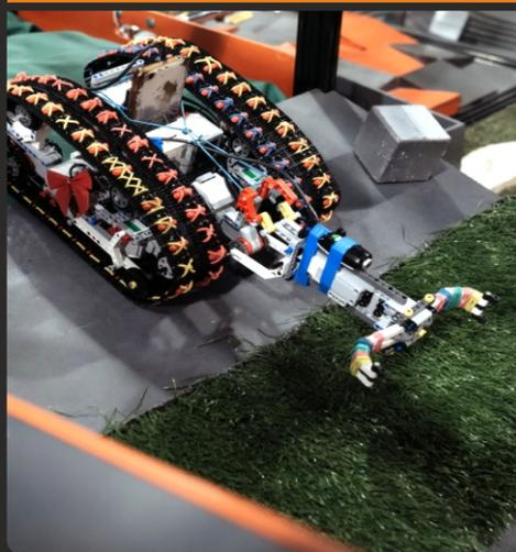
Испытание представляет собой наклонную 15°, с габаритными размерами 740x690x200, на которой закреплена полоса искусственной травы. Высота ворса – 40 мм. Ширина искусственной травы может варьироваться, от 200 мм до всей поверхности наклонной.
