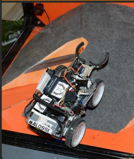
Конструкция, представляющая собой резкий подъем (30°), поворот и спуск (30°). Конструкция покрыта ковровином для лучшего сцепления с поверхностью при подъеме и спуске. Высота подъема – 200 мм.
