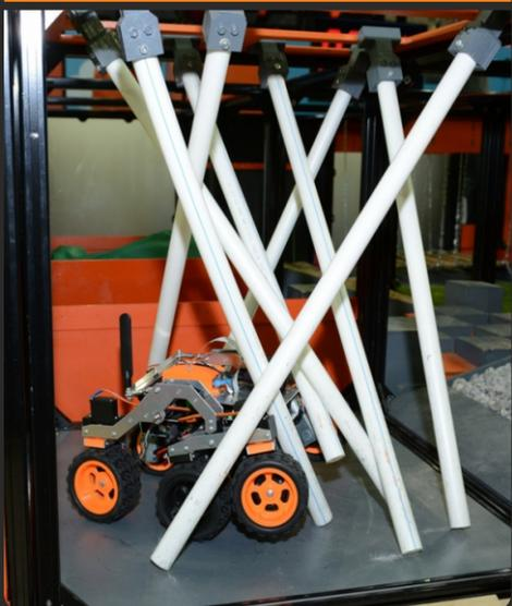
Испытание представляет собой стандартный кубик полигона, крышка которого вырезана из фанеры, к которой с помощью металлических карточных петель прикреплены разнонаправленные полипропиленовые трубы. Таким образом трубы преграждают путь через кубик.
