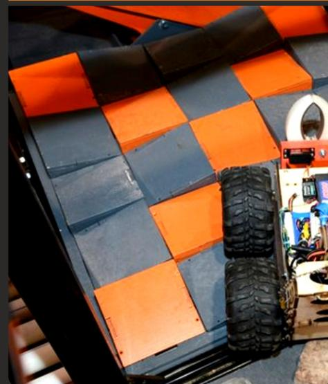
Испытание представляет собой стандартную наклонную 15°, с габаритными размерами 740x690x200 мм, заполненную коробами с углом наклона 15°, разной направленности. Рампы - разной высоты с перепадом высот 50 мм.
