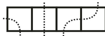
**6.3.** Ячейка засчитывается, если робот въехал в нее всей базой, и выехал с другого конца (исключение – тупиковые ячейки)
