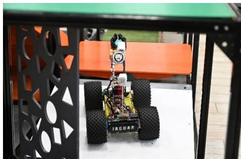
Плоская площадка, качающаяся на продольной оси, проходящей посередине ячейки. Максимальный угол наклона качели составляет около 30°. Равновесие считается нарушенным (наклон) если качели наклонились на максимальный угол (в крайнее положение).
