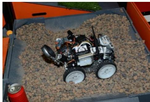
Короб глубиной 40 мм, наполненный керамзитом. Высота керамзитного слоя колеблется в пределах 20-30 мм.
