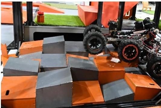
Ячейка заполнена 25-ю закрытыми коробами (рампами). Верхняя грань каждого короба имеет наклон в 15°. Рампы составлены таким образом, что их верхние поверхности образуют по высоте неравномерную структуру. Рампы разной высоты с перепадом высот более 50 мм.
