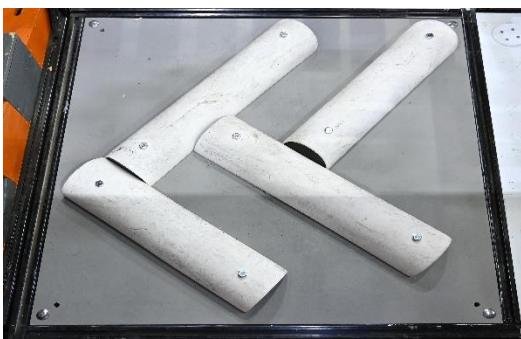
Испытание представляет собой ячейку с расположенными в форме «ёлочки» половинами продольно распиленных полипропиленовых труб диаметром 110 мм
