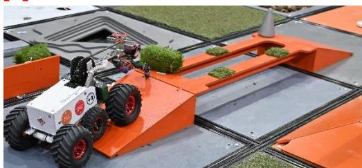
Испытание представляет собой узкую деревянную площадку со сквозным отверстием в центре и травой на отдельных участках испытания
