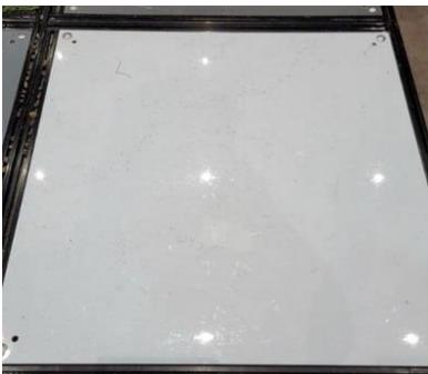
Скользкая поверхность (фторопластовая пластина). Для большей скользкости на поверхность может наноситься универсальная смазка WD-40 или ее аналог.
