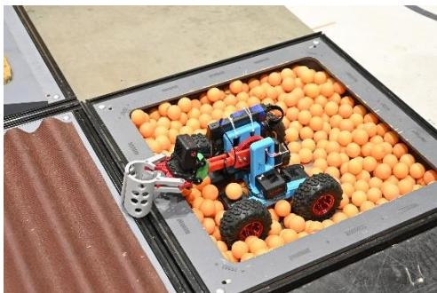
Слой шариков для пинг-понга толщиной от 40 до 150 мм, в глубоком коробе без вспомогательных выездов. Диаметр шарика - 40 мм.
