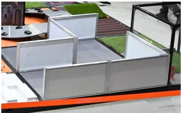
Роботу необходимо в автономном режиме проехать по коридору, состоящему из белых стенок. На полу не нанесено дополнительных линий, робот может ориентироваться только на изгибы самих стенок. Высота стен – 400 мм, расстояние между стенками – 800 мм. Стены коридора изгибаются под 90°. Коридор состоит из трех ячеек.
