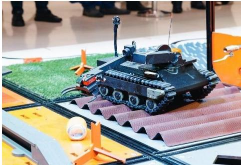
Отрезок волнистого кровельного материала (ондулина). Высота волны 38 мм, период волны 95 мм.
