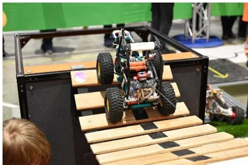
Подвесной мост собран из деревянных планок, закрепленных на стропах. Промежуток между планками составляет 15-20 мм. Длина моста варьируется, ширина 300 или 400 мм. На мосту может быть нанесена линия контрастного цвета шириной 40 мм для автономного прохождения
