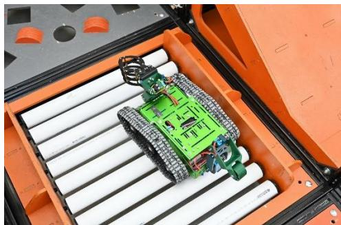
Пол ячейки представляет собой роликовый конвейер из вращающихся вдоль продольной оси полипропиленовых труб.
