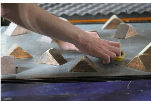
Плоская площадка, на которой закреплены деревянные призмы. Высота шипа – 40 мм, длина грани – 50 мм, ширина шипа – 40 мм.
