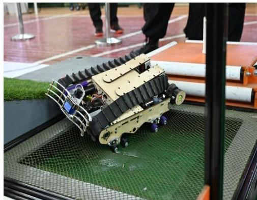
Рамка, на которую натянута сетка. Размер ячейки в сетке – 10x10 мм.
