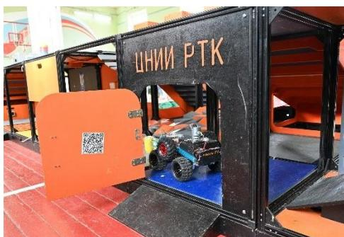
Дверь, открывающаяся на 90° на себя и от себя с ручкой типа «штанга». Габаритные размеры двери - 480x480 мм. Высота ручки двери над полом – 220 мм, толщина – 8 мм, длина – 110 мм. Испытание размещается в одном кубе, в котором может находиться дополнительное испытание.
