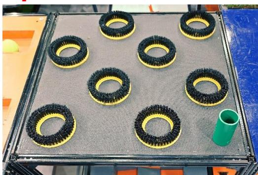
Испытание представляет собой плоскую ячейку, покрытую ковролином, с расположенными в шахматном порядке элементами в форме кольца диаметром 160 мм со щетиной. Высота щетины: ориентировочно 60 мм
