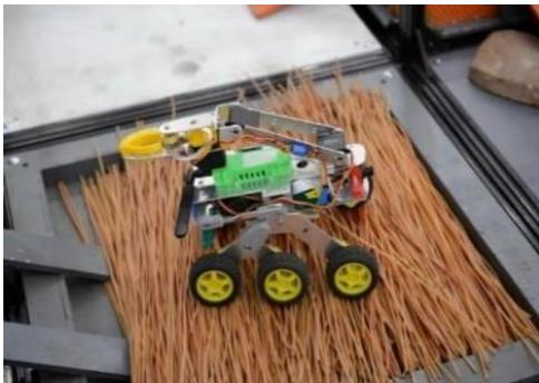
Короб глубиной 40 мм, заполненный проводами. Глубина слоя 20-30 мм.
