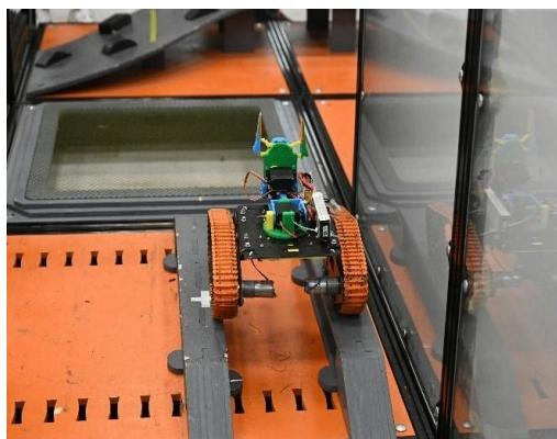
В площадке ячейки проделаны отверстия, в которые вставляются штифты коробов, имитирующих рельсы. Ширина постановки рельс регулируется под ширину базы робота, стартующего с ближайшего старта.
