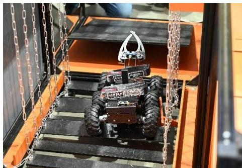
Мост набран из деревянных планок, подвешенных на цепях к верхним ребрам куба. Ширина моста - 500 мм, планки - 65 мм, расстояние между планками - 35 мм. Все планки моста попарно соединены цепочкой, раздвигаются между собой на ширину не более 65 мм. Высота моста относительно пола ячейки - 80 мм. На планках может быть нанесена белая полоса шириной 40 мм для автономного прохождения.
