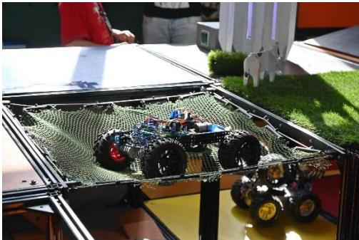
Подвесной мост из сетки закреплен между кубами при помощи натянутых тросов.
