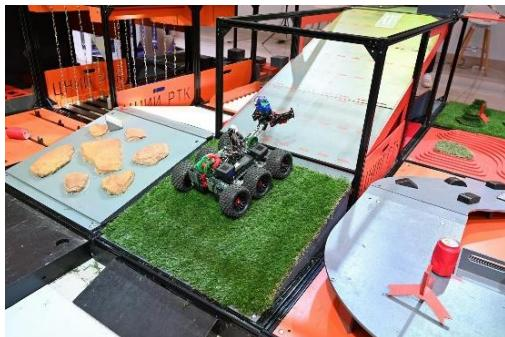
Плоская площадка, установленная под углом 20°. Состоит из 2х ячеек. Въездом на нее служит стандартная наклонная 15°.
