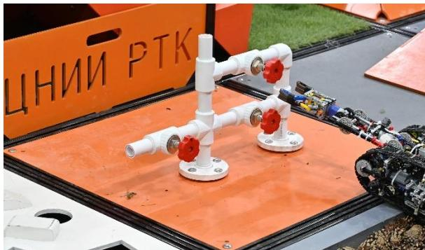
Испытание представляет собой смоделированную устьевую арматуру нефтяного месторождения с расположенными на ней круглыми вентилями (3 шт.). Участникам необходимо перекрыть утечку нефти вращая вентили. Для перекрытия необходимо повернуть вентиль на 360°
