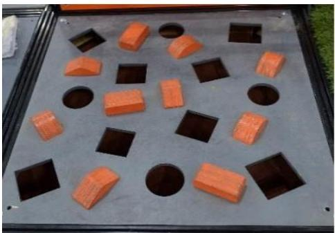
Плоская площадка с отверстиями различной формы. Также, на площадке в произвольном порядке расположены препятствия – шипы из фанеры различной формы. Высота шипа - 50мм. Ширина отверстий до 120 мм.
