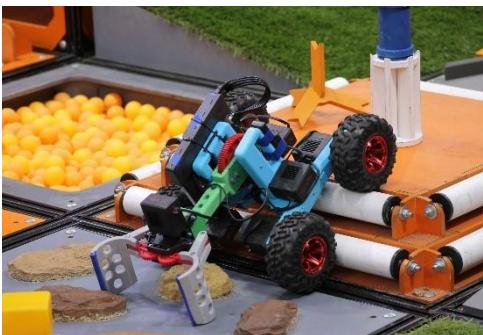
Ступенчатая пирамида, состоящая из двух уровней. Параллельно длинным ребрам каждого уровня закреплены вращающиеся трубы. Общая высота – до 140 мм. Высота ступени – 60 мм.
